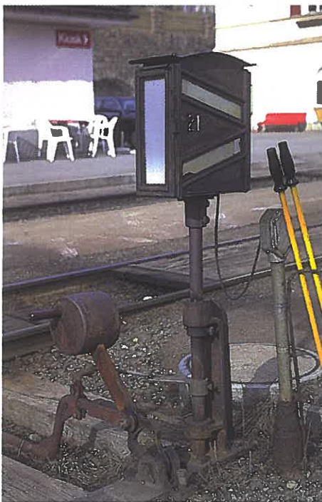
Diese alte Form der Weichenlaterne in Disentis ist leider nur noch selten anzutreffen. Interessant ist die Mechanik und die Zuführung der elektrischen Energie für die Beleuchtung. Die beiden angelehnten gelben Stangen dienen zur Kontrolle der Bremsbacken bei der Bremsprobe.
