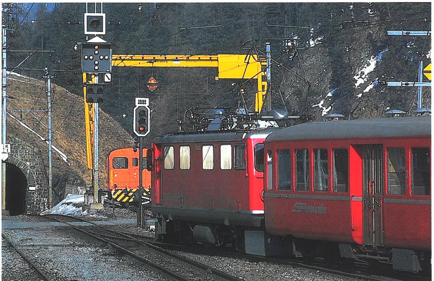
Aus St. Moritz ausfahrender Regionalzug nach Scuol und eine Anzahl verschiedener Signalisierungen. Links vor dem Tunnelportal der Neigungsanzeiger mit dem Hinweis auf die Funkkanäle. Links oben zeigt das Rangiersignal »Halt für Rangierbewegungen«, das darüber befindliche Blinklicht signalisiert die geschlossene Bahnschranke. Darunter ist ein Kombisignal für Bremsprobe und Abfahrtsbefehl angebracht. Das Ausfahrtsignal zeigt den Fahrbegriff 2. Oberhalb davon gibt ein Schild den Hinweis auf die Bahnschranke. Oberhalb der Ge 4/4 1 und rechts oben sind an den Abstellgleisen die Stromabnehmer-Senksignale sichtbar.
