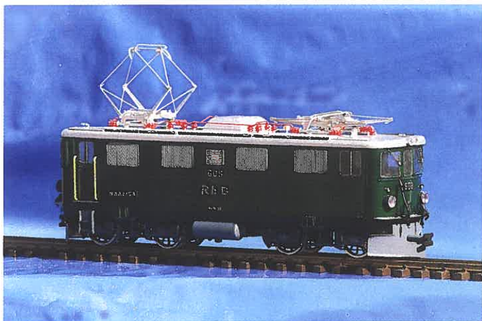
Dr. med. Egbert Nolte: Ich habe inzwischen neben einigen Dutzend Waggons auch drei Lokomotiven unter Verwendung von LGB-Teilen im Maßstab 1:22,5 selbst gebaut. Im Bild ist die Ge 4/4 I der RhB zu sehen. Das Gehäuse habe ich mit der Laubsäge aus Messing ausgesägt.
