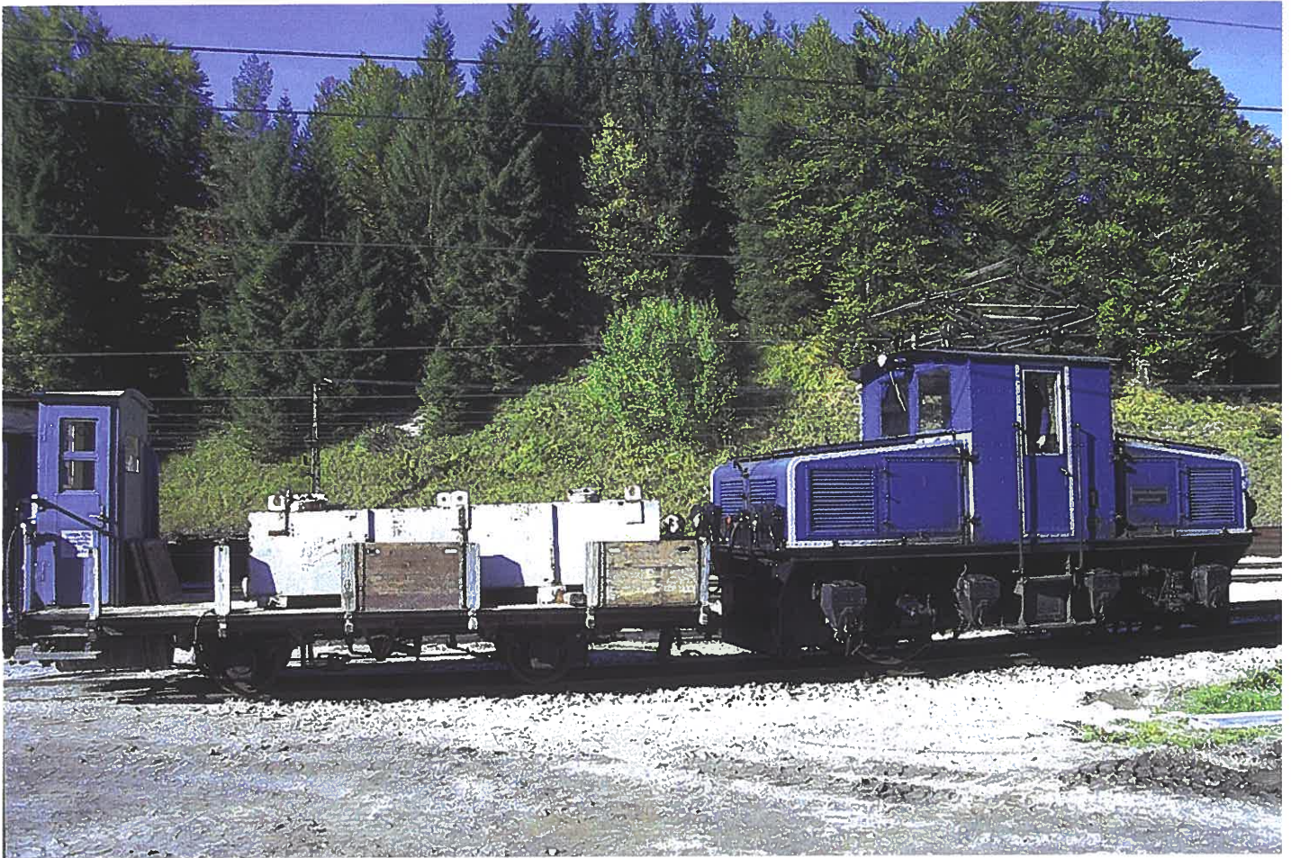
Tallok 1 m Depotgelände in Grainau. Links steht ein Güterwagen mit Bremserhaus, der immer bergwärts gekuppelt wird und stets mit einem Zugbegleiter besetzt ist.
