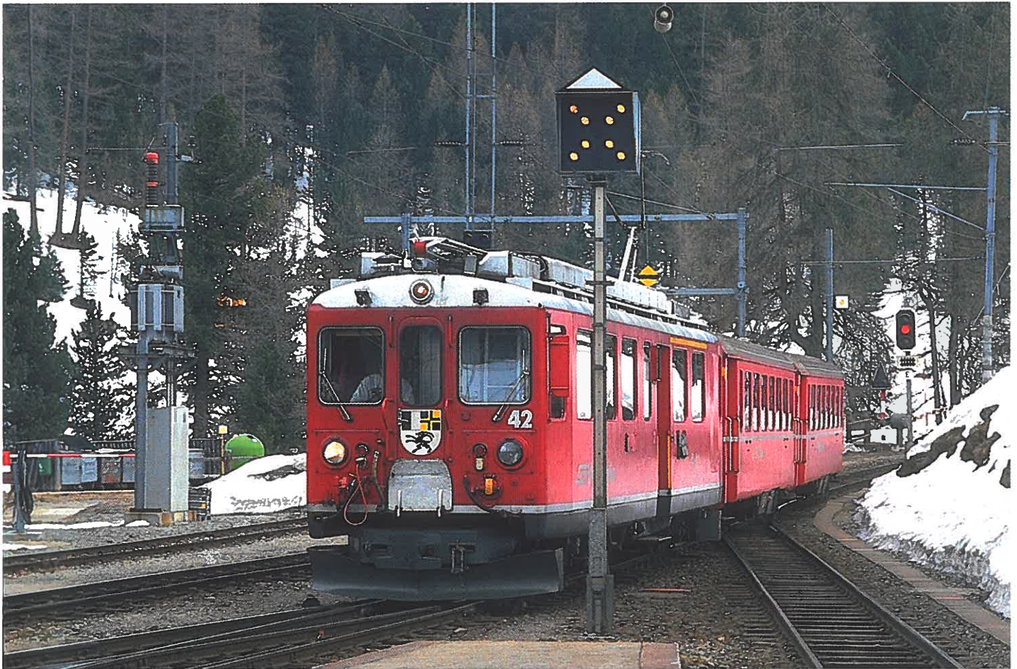
Nach Pontresina einfahrender Regionalzug vom Beminapaß. Das Räumungssignal zeigt Rangieren verboten. Ferner sind auf dem Bild zwei Kombisignale, das Ausfahrtsignal mit dem Barrenhinweis, das Blinklicht für die geschlossene Barriere, am Bahnübergang die Warntafel mit Blinklicht und oberhalb des Triebwagens das Stromabnehmer-Senkensignal zu sehen.
